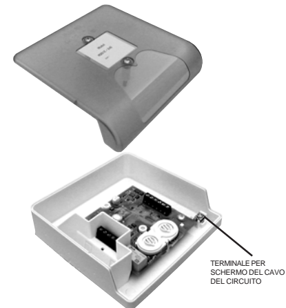
Figure 2: Cablaggio del modulo.
