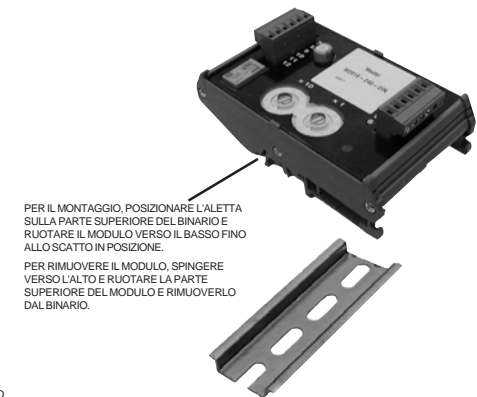
Figura 1b: Modulo di uscita montato su binario Din M901RDIN con contatti di relè da 240 V.
